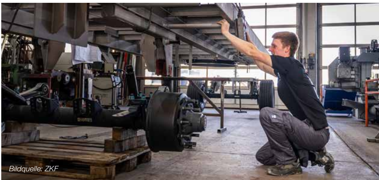
Lehrling in der FR Karosserie- und Fahrzeugbautechnik bei der Montage einer Achse
