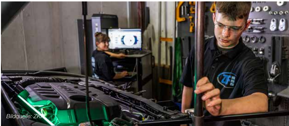
Lehrlinge in der FR Karosserieinstandhaltungstechnik beim Vermessen einer Karosserie
